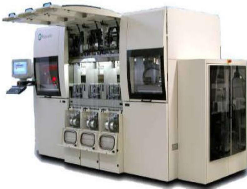
※为了防止外部环境的冲击，利用**EMC**把**Wire Bonding**完成后的产品封装起来的过程，并需要加热硬化。
